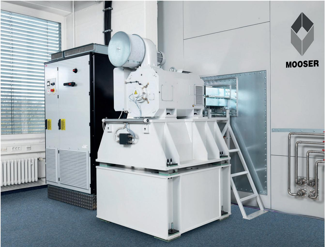
**Blick hinter die Kulissen: Antriebs- und Bremseinheit einer eCHAMBER mit einer Leistung von 250 kW.** © Mooser
