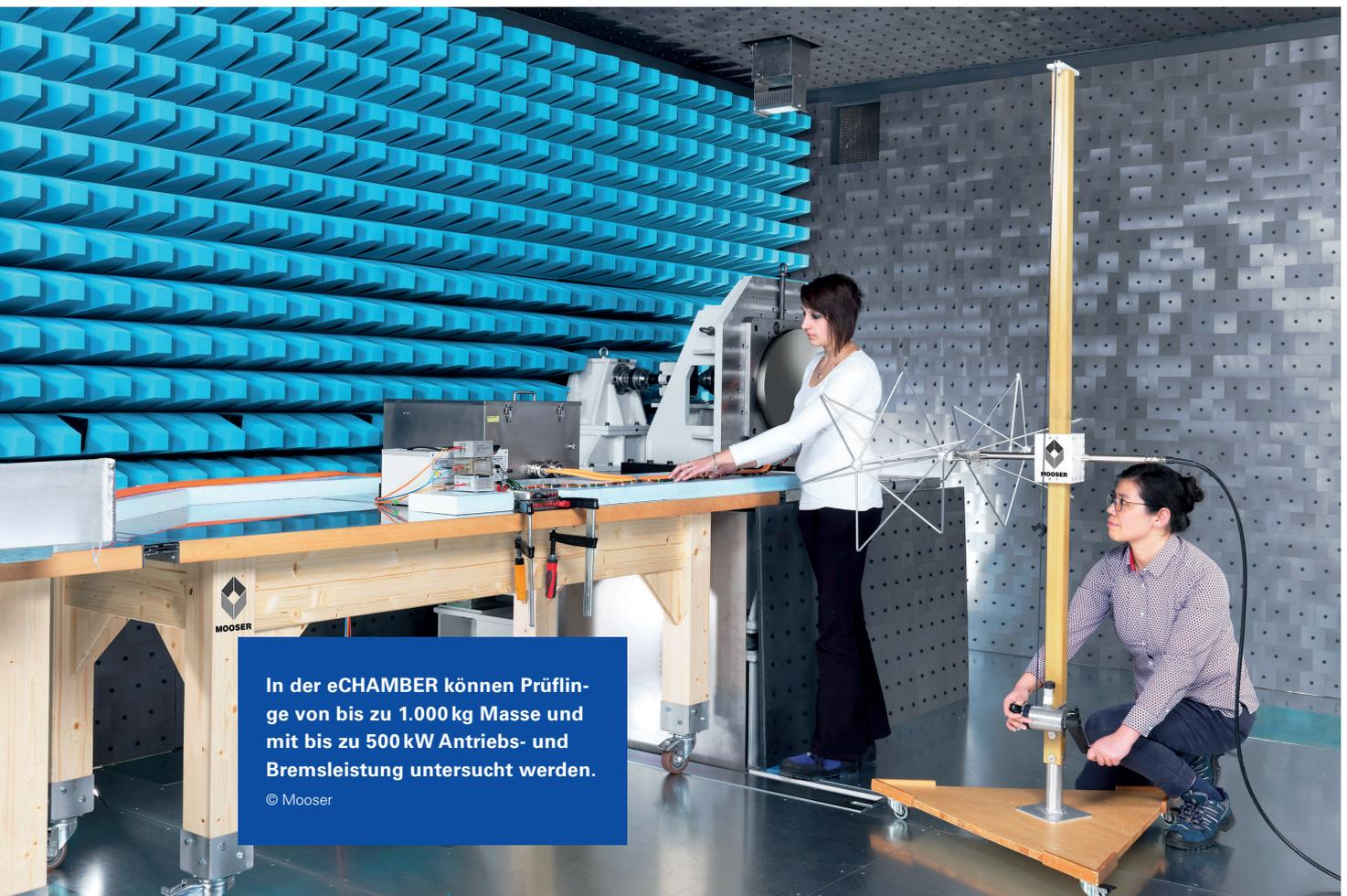
In der eCHAMBER können Prüflinge von bis zu 1.000 kg Masse und mit bis zu 500 kW Antriebs- und Bremsleistung untersucht werden.
